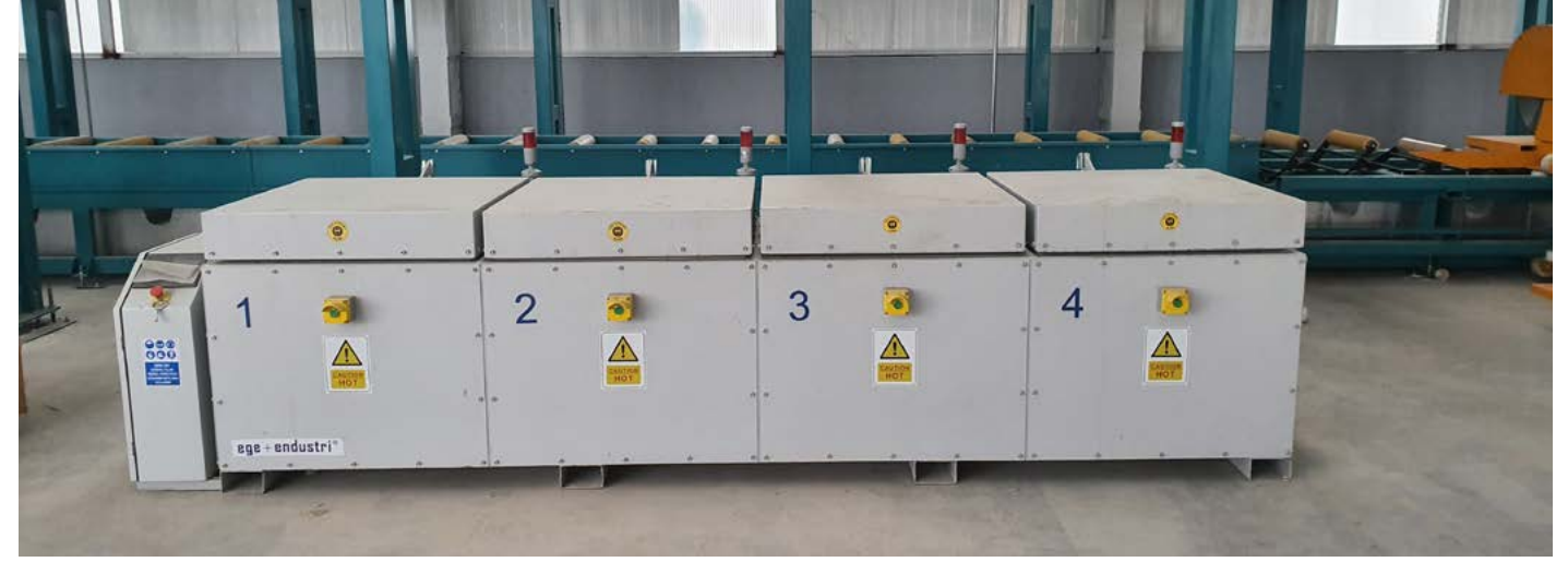
PLC and Touch Screen Controlled Single Cell Die Ovens PLC ve Dokunmatik Ekran Kontrollü Tek Hücre Kalıp Fırınları
